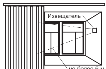
Рисунок 9 – Установка извещателя между стеклом и занавесями (жалюзи)
