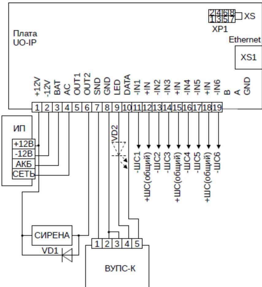
Рисунок А.1 – Схема соединений для проверки ППКО после монтажных работ
