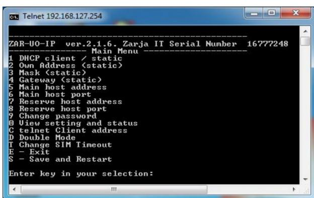
Серийный номер (Serial Number), отображаемый на экране, должен совпадать с номером на плате ППКО.
